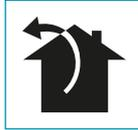
Tässä versiossa savut ja höyryt johdetaan ulkotilaan poistoputken kautta. Tätä varten liesituulettimen ilmanpoistoliitos on liitettävä putkeen, jossa on ulkoinen poistoaukko.
