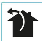
In deze versie wordt de rook en damp via een afvoerbuis naar buiten afgevoerd. Hiervoor moet de uitlaatfitting van de kap via een buis met een externe uitgang aangesloten worden.
