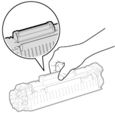
**Не прикасайтесь к устройству памяти картриджа с тонером (A) или электрическим контактам (B).**
