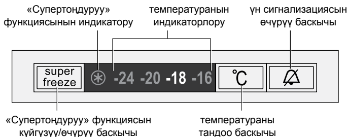
3-сүрөт – Башкаруу панели
