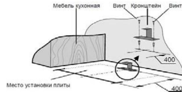
Рисунок 7 – Порядок установки кронштейна
