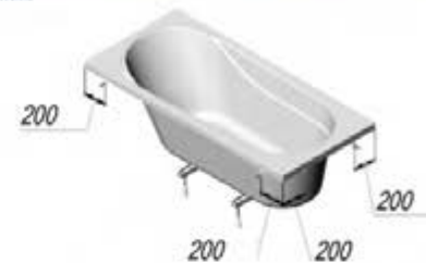
Рисунок 6 – крепление ванны к стене
