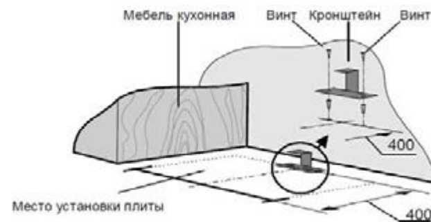
Рисунок 7 – Порядок установки кронштейна
