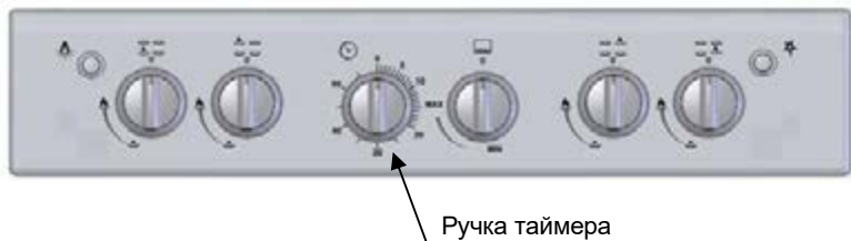
Рисунок 3а – Панель управления с таймером
