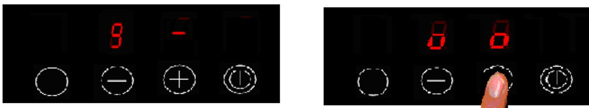
Если выключить блокированную плиту с помощью клавиши включить/выключить, она будет блокирована, пока ее повторно не запустят с помощью клавиши включить/выключить, а при попытке включения появляются две малые буквы „o” в течение примерно 1 секунды.
