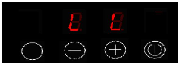
Если на дисплее показывается „FL” - это значит, что контроллер слишком ярко освещен, на пример от галогенной лампы. В таком случае выключите свет и контроллер начинает продолжать работу.
