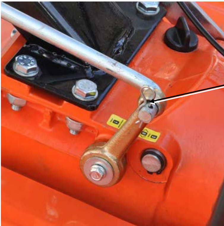
Зашплинтованный удлинитель рычага переключения передач
