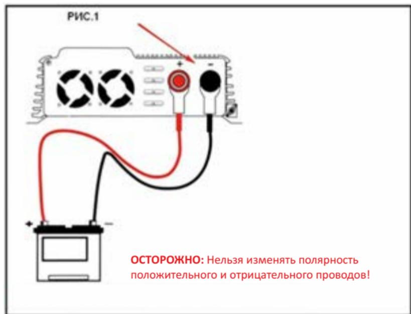
РИС.1: Подключите преобразователь к аккумулятору, используя красный провод на плюсовой вывод аккумулятора, чёрный провод к минусу источника электропитания. Крепко закрепите провода. Внимательно проверьте, чтобы клеммы «+» и «-» были закреплены согласно рисунку «РИС.1».
