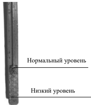
Рисунок 5 – Проверка уровня масла в корпусе редуктора
