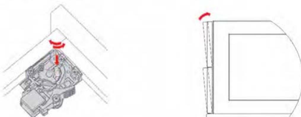
2. Дополнительная регулировка фасада по вертикали и горизонтали.
