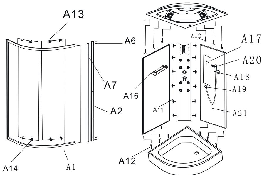
При монтаже стекол кабины, будьте внимательны! Не ставьте стекла на кафельный пол без защитного картона, избегайте ударов и падения стекол на угол!
