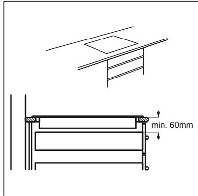
**i** В случае установки прибора над выдвижным ящиком система вентиляции варочной поверхности может во время приготовления нагревать предметы, хранящиеся в ящике.
