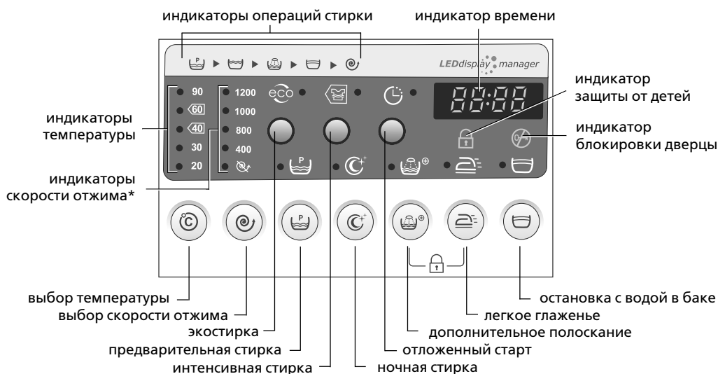
Рисунок 3 — Зоны индикации и кнопки выбора дополнительных функций
