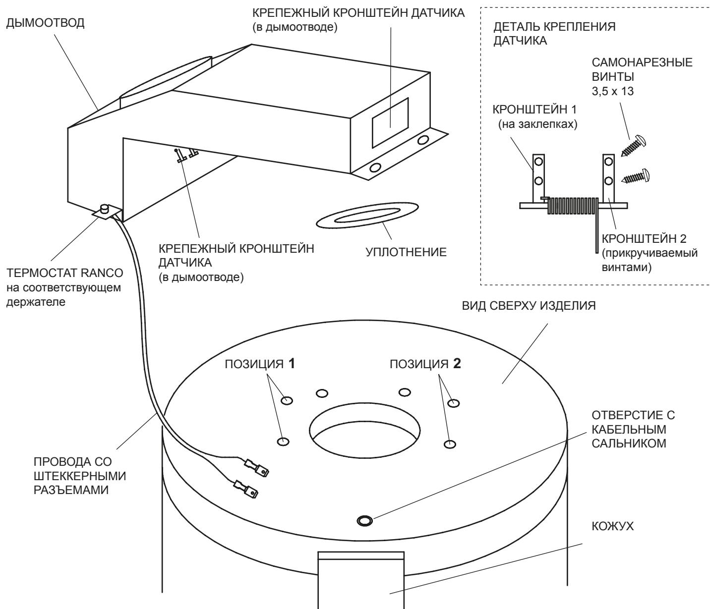
1. Проверьте, чтобы дымоотвод соответствовал установленному изделию по шильдику.
