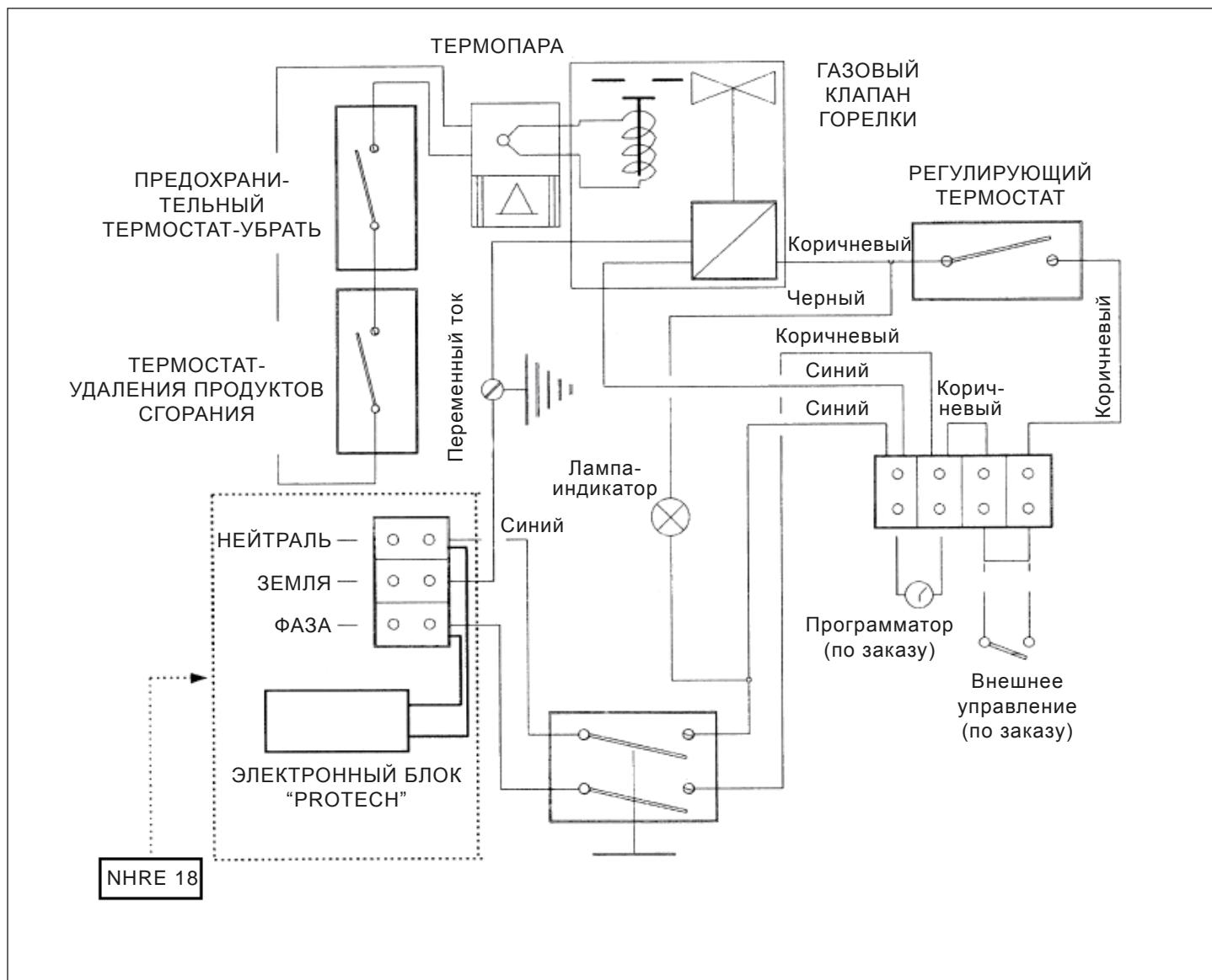
Нормальное функционирование защитной системы PROTEHC требует подключения к питанию 230 В, см. §§3.1 и 3.2
