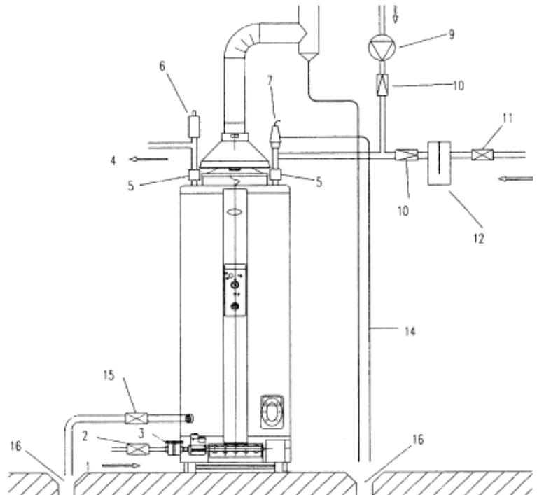
Принципиальная схема с двумя параллельными водонагревателями (сх. 8)
