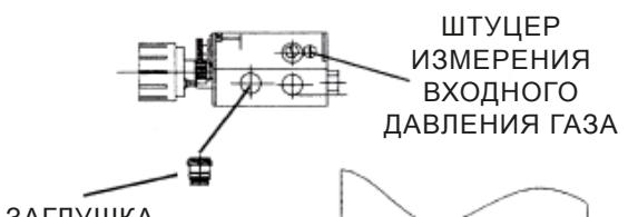
ШТУЦЕР ИЗМЕРЕНИЯ ДАВЛЕНИЯ НА ВЫХОДЕ
