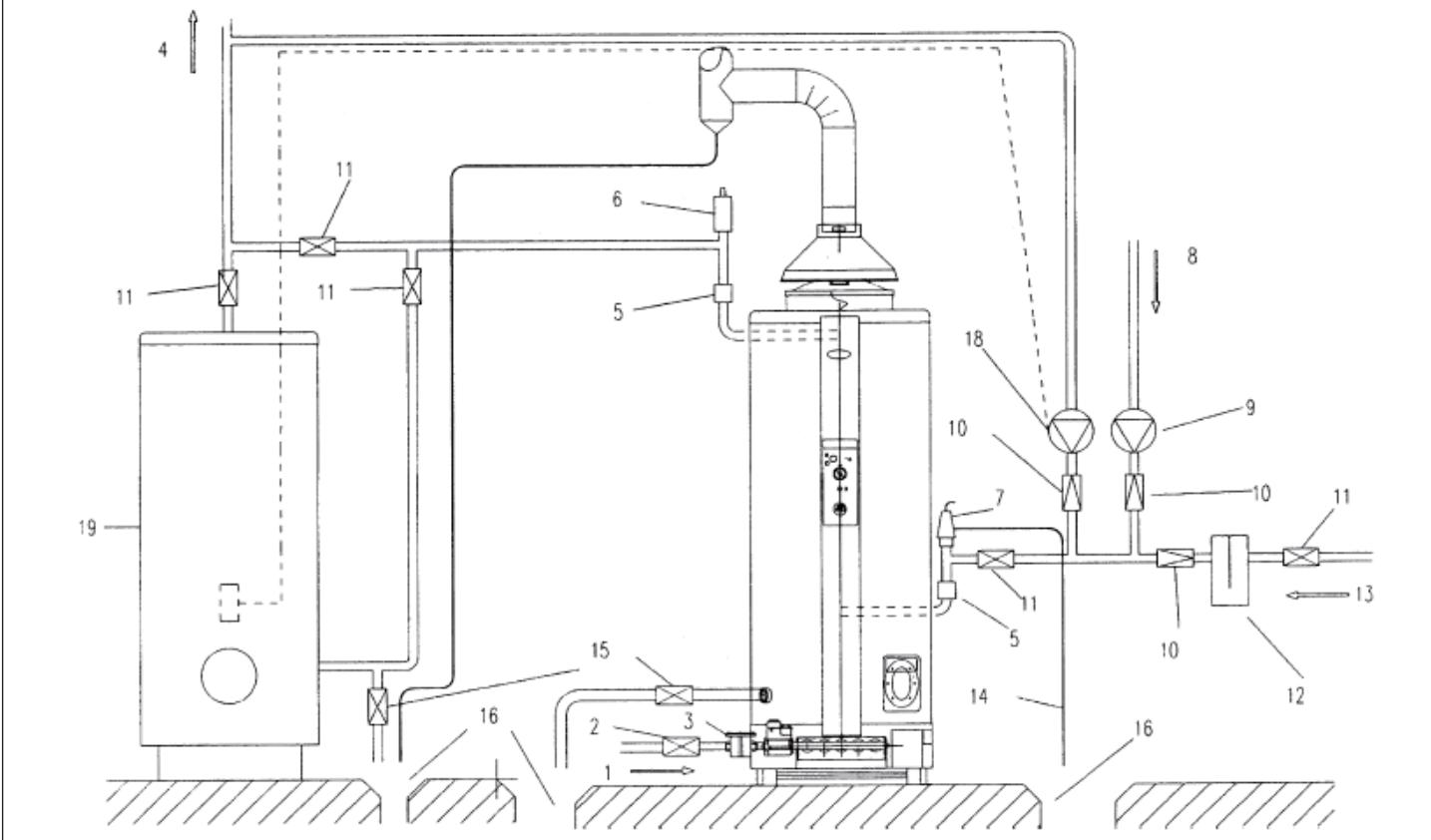
Принципиальная схема с двумя параллельными водонагревателями и одним накопительным резервуаром для хранения воды (сх. 14)
