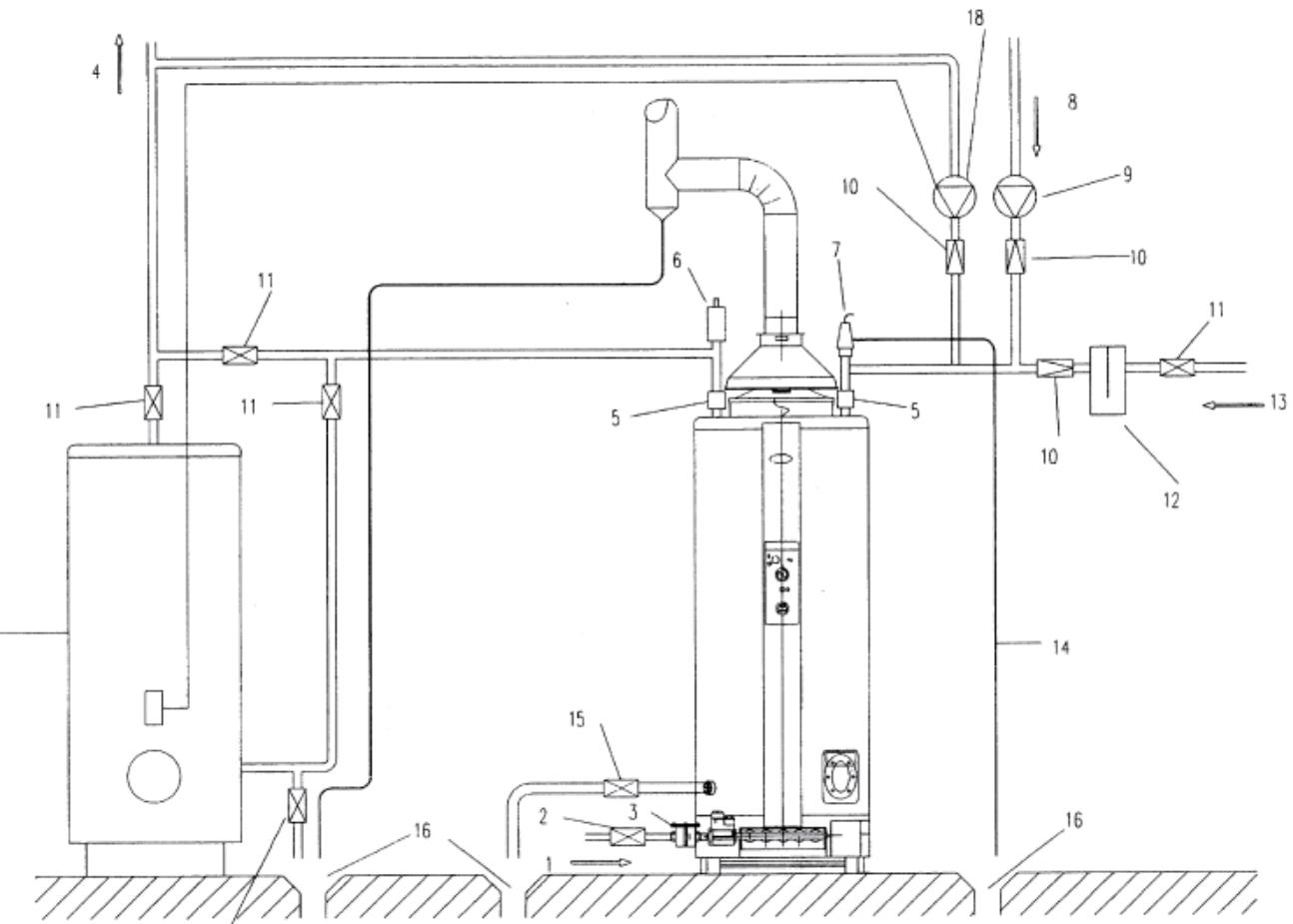
Принципиальная схема с двумя параллельными водонагревателями и одним накопительным резервуаром для хранения воды (сх. 10)
