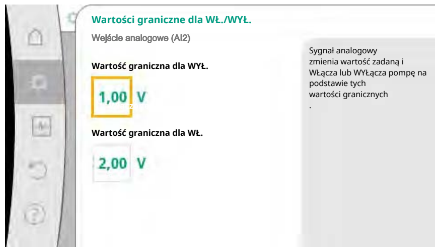
Fig. 74: Wartości graniczne sterowania WŁ./WYŁ. za pomocą sygnałów analogowych
