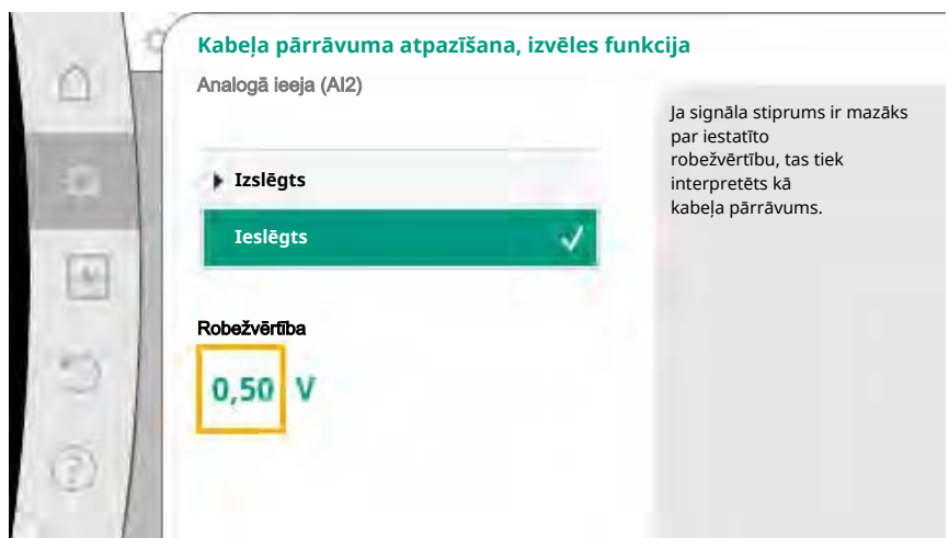
Fig. 72: Robežvērtība, kabeļa pārrāvums
