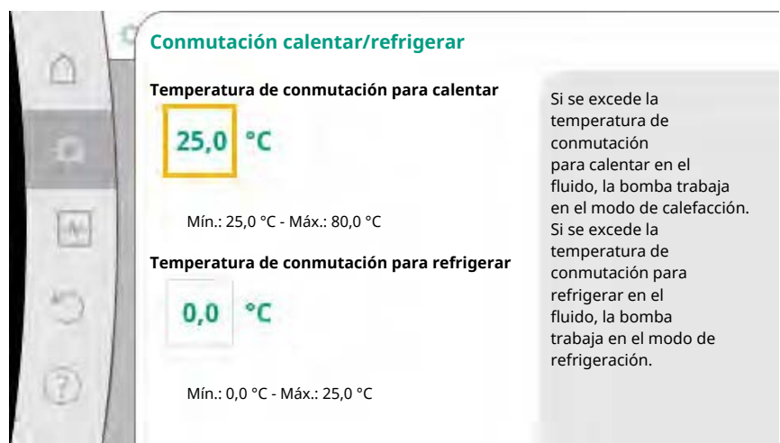
Fig. 57: Conmutación calentar/refrigerar_Temperaturas de conmutación
