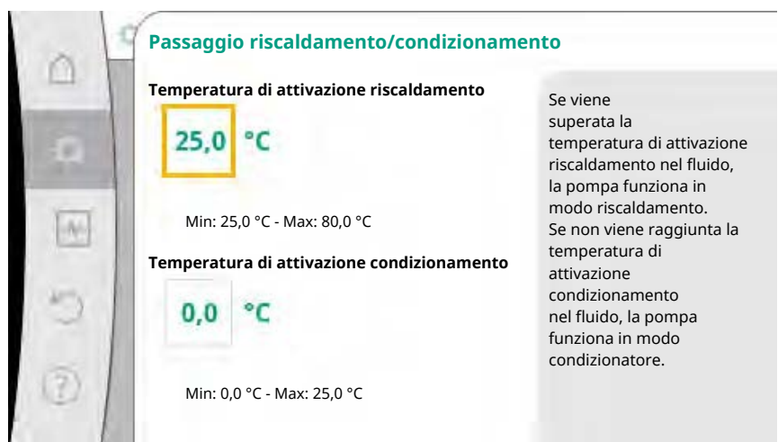
Fig. 57: Passaggio riscaldamento/condizionamento_Temperature di commutazione
