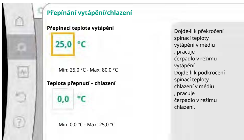
Fig. 57: Přepínání vytápění/chlazení_ teploty přepnutí
