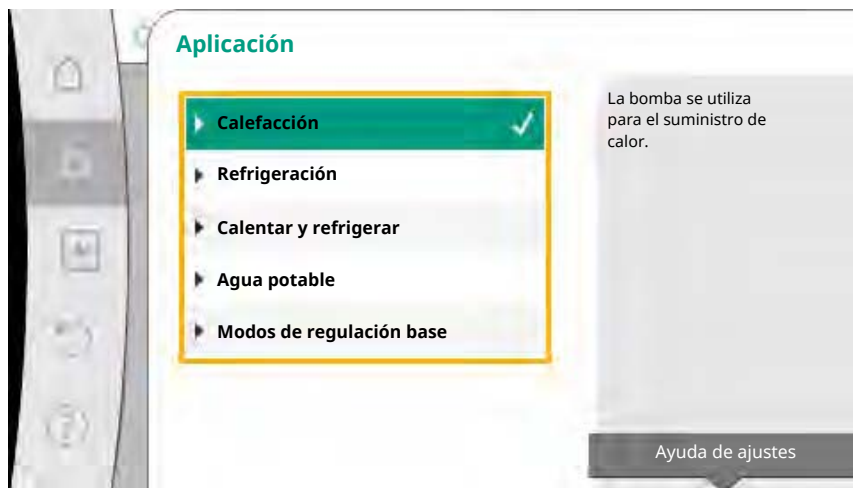
Fig. 46: Ejemplo aplicación «Calefacción»
