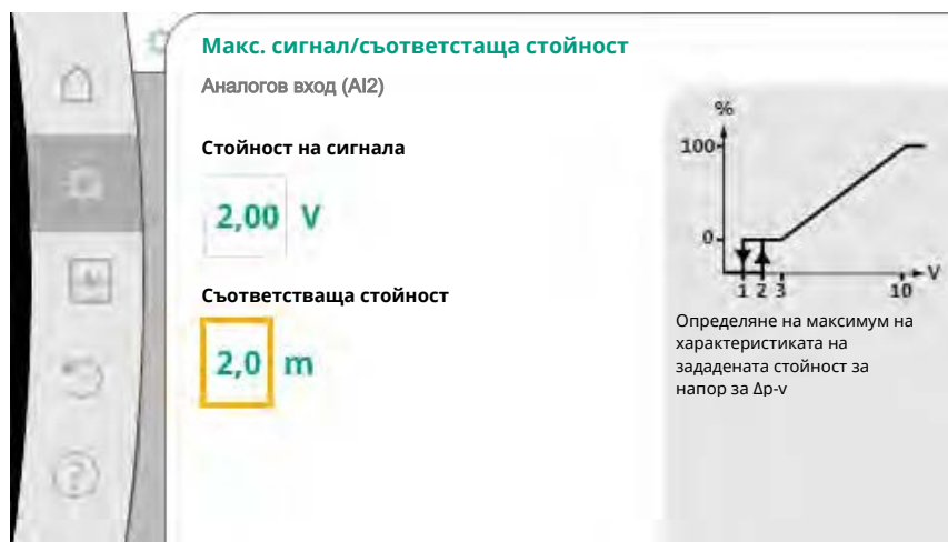
Fig. 76: Макс. сигнал/съответстваща стойност
