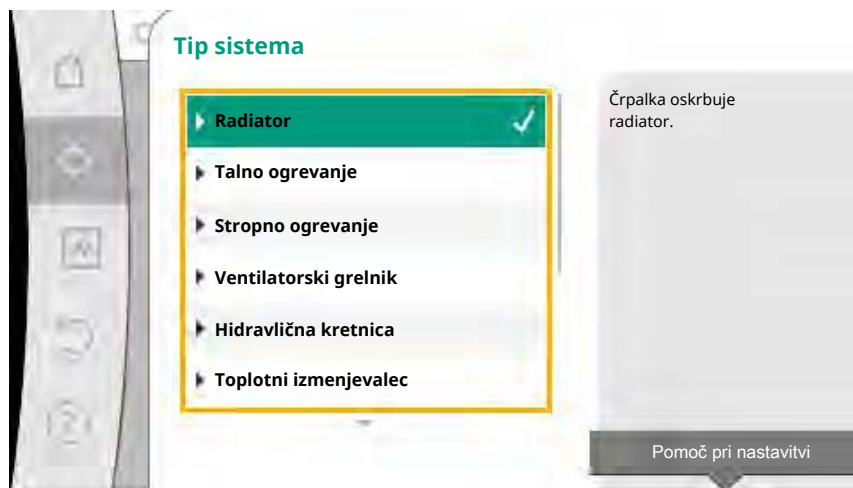
Fig. 47: Primer vrste sistema »Radiator«
