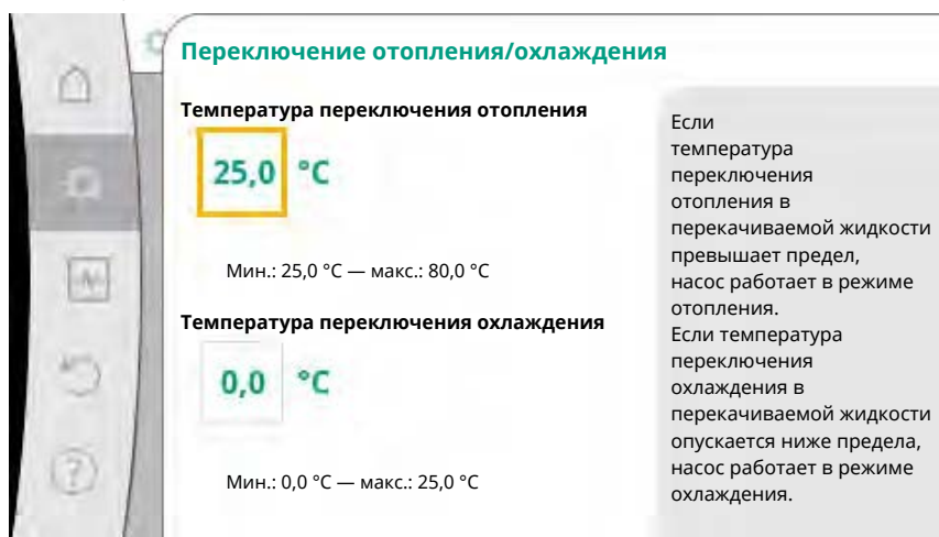
Fig. 57: Переключение отопления/охлаждения_Температуры переключения
