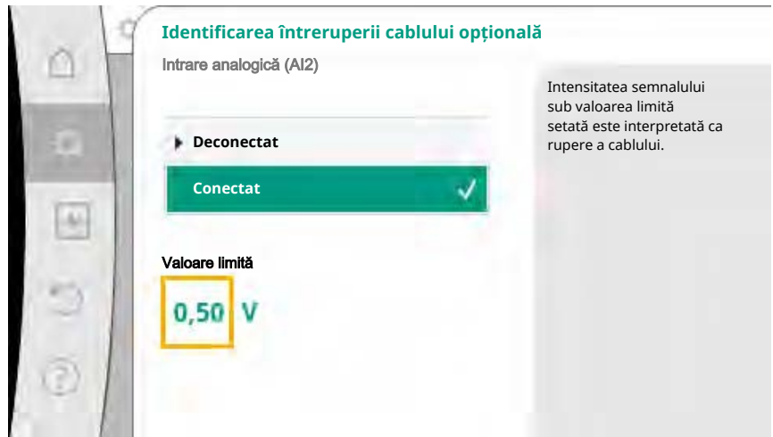
Fig. 72: Valoare limită cablu rupt
