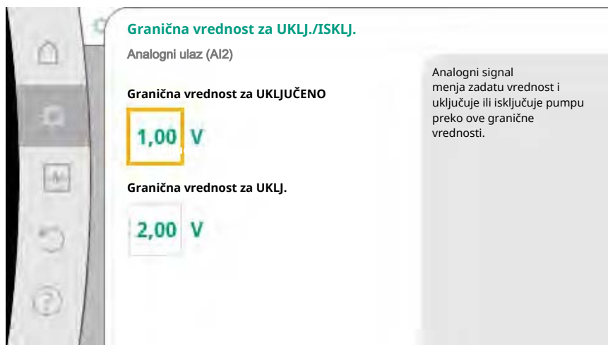
Fig. 74: Granične vrednosti za upravljanje uključivanjem/isključivanjem putem analognih signala
