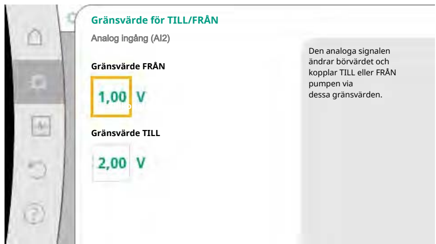
Fig. 74: Gränsvärden för TILL/FRÅN-styrning via analog signal
