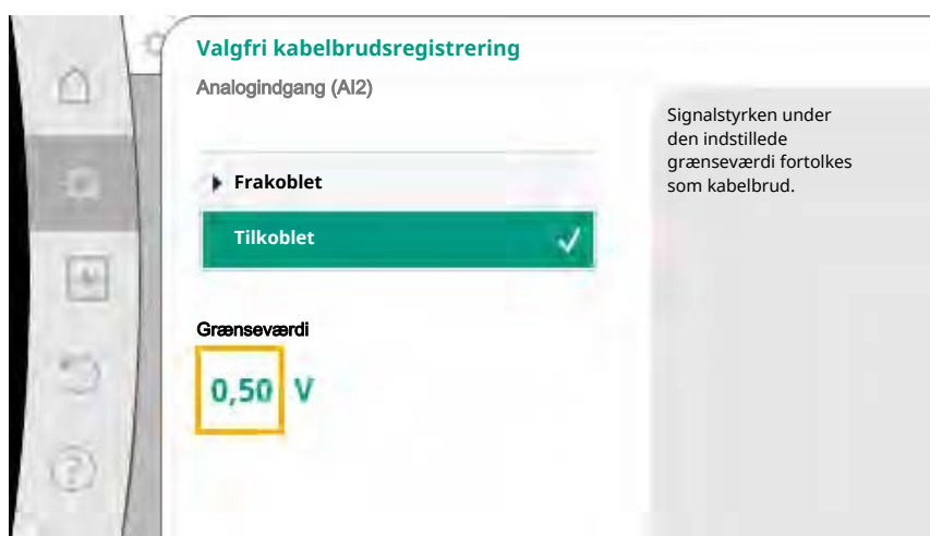
Fig. 72: Grænseværdi for kabelbrud
