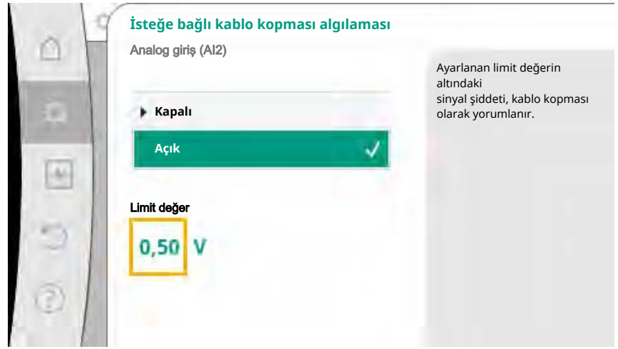
Fig. 72: Limit değeri kablo kopması
