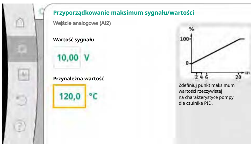
Fig. 81: Przyporządkowanie maksimum sygnału/wartości
