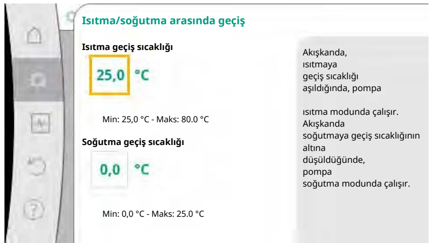
Fig. 57: Isıtma/soğutma_geçiş_sıcaklıkları arasında geçiş
