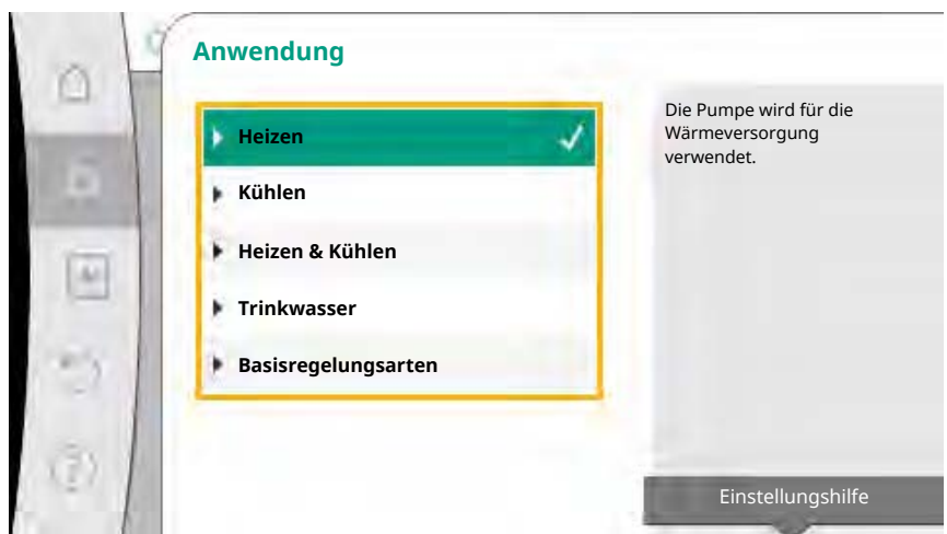
Fig. 46: Beispiel Anwendung „Heizen“
