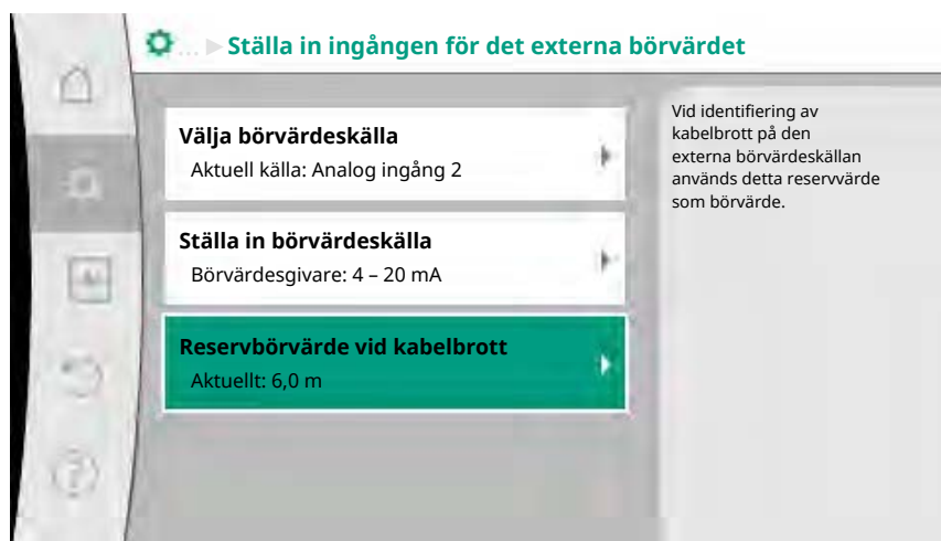
Fig. 77: Reservbörvärde vid kabelbrott
