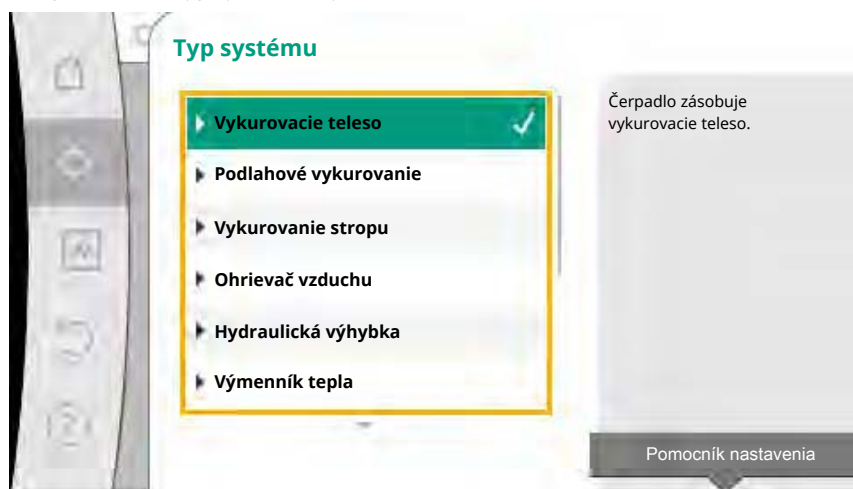
Fig. 47: Príklad typu systému „Vykurovacie teleso“
