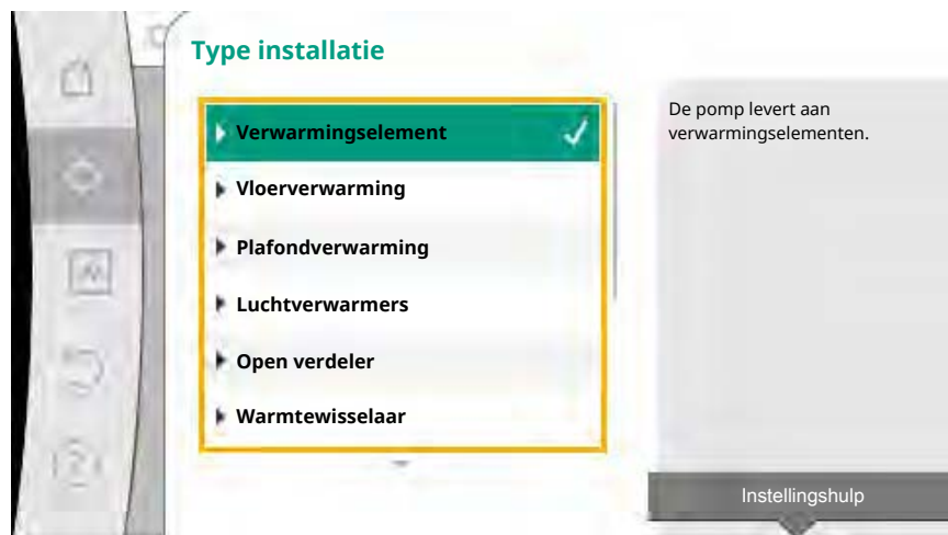
Fig. 47: Voorbeeld installatietype „Verwarmingselement”
