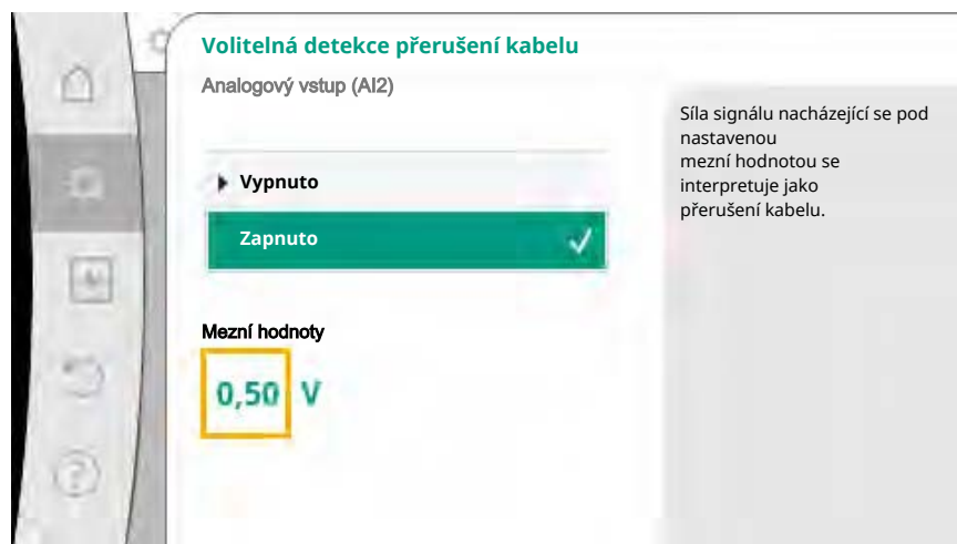
Fig. 72: Mezní hodnota – přerušení kabelu
