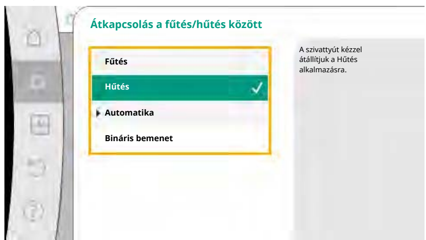
Fig. 55: Átkapcsolás a fűtés/hűtés között_Hűtés
