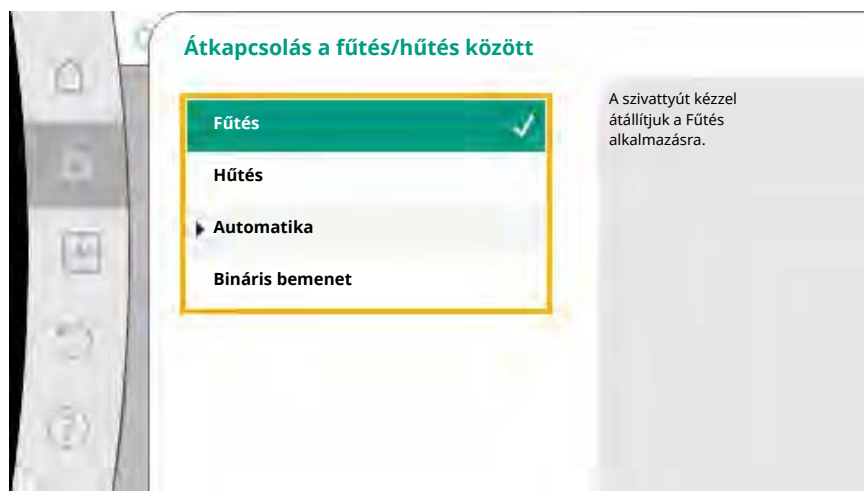
Fig. 54: Átkapcsolás a fűtés/hűtés között_Fűtés
