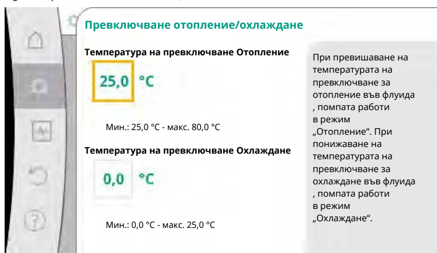
Fig. 57: Превключване отопление/охлаждане_температури на превключване
