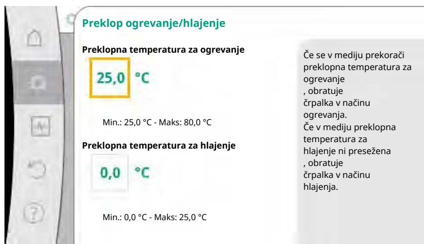
Fig. 57: Preklop ogrevanje/hlajenje_preklopne temperature
