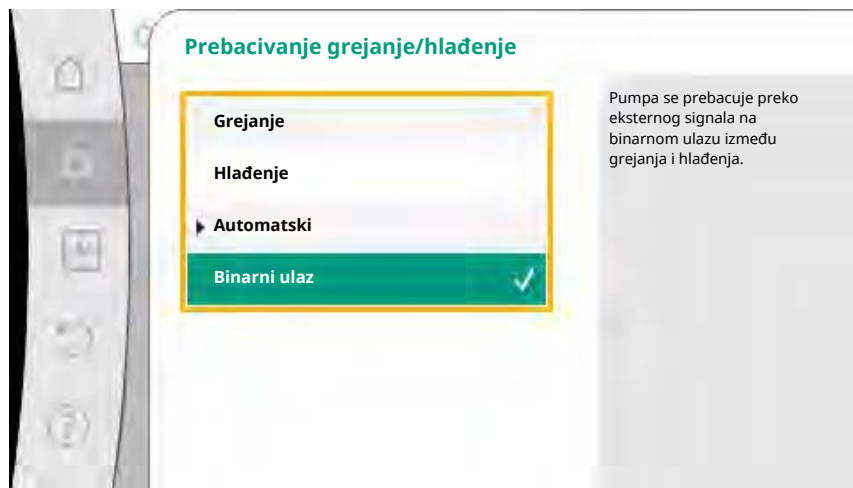
Fig. 58: Prebacivanje grejanje/hlađenje_Binarni ulaz
