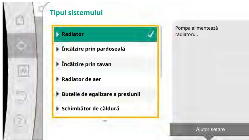
Fig. 47: Exemplu tipul de instalație „Radiator“
