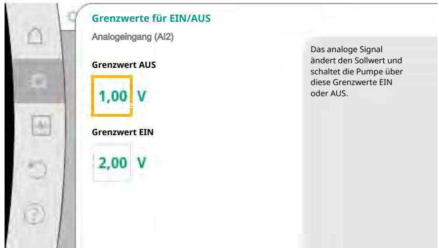
Fig. 74: Grenzwerte zur EIN/AUS-Steuerung über Analogsignale
