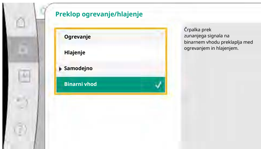
Fig. 58: Preklop ogrevanje/hlajenje_binarni vhod
