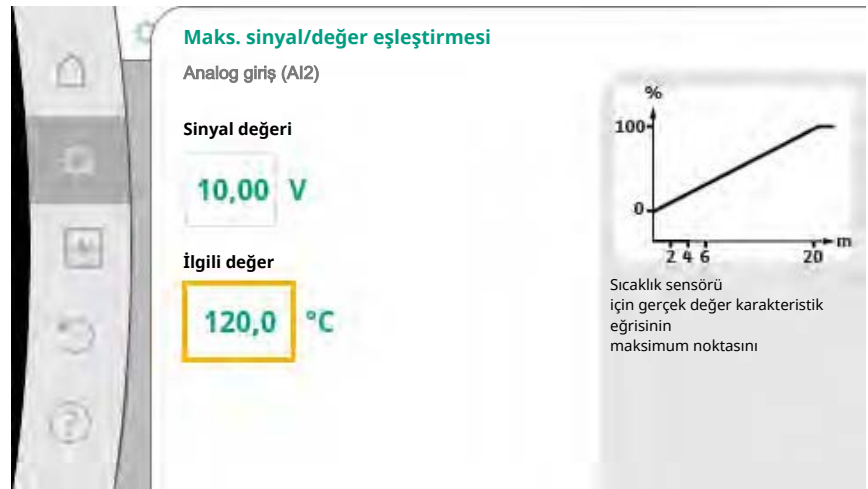
Fig. 81: Maks. sinyal/değer eşleştirmesi gerçek değer sensörü
