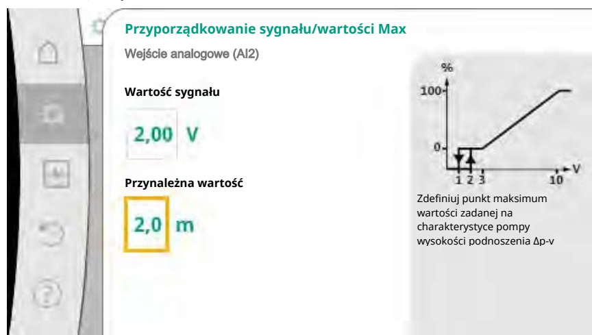
Fig. 76: Przyporządkowanie maksimum sygnału/wartości
