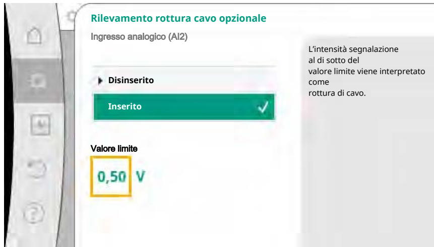
Fig. 72: Valore limite rottura di cavo
