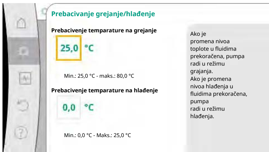
Fig. 57: Prebacivanje grejanje/hlađenje_Prebacivanje temperature
