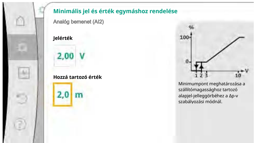
Fig. 75: Minimális jel és érték egymáshoz rendelése
