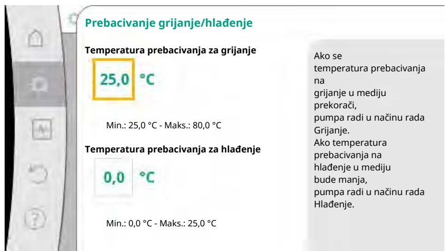
Fig. 57: Prebacivanje grijanje/hlađenje_temperature prebacivanja
