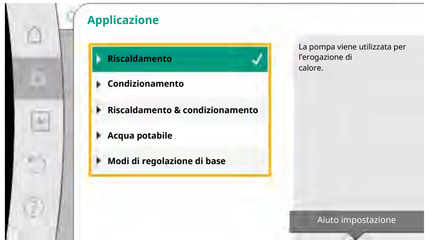
Fig. 46: Esempio applicazione “Riscaldamento”
