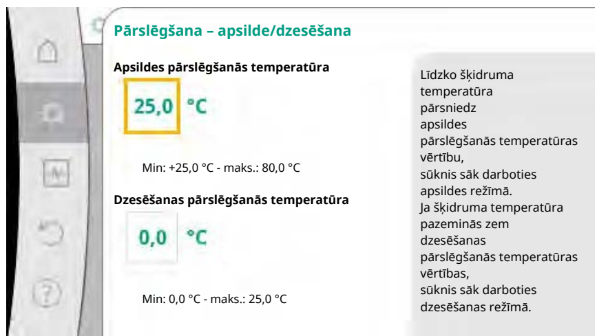
Fig. 57: Pārslēgšana – apsilde/dzesēšana_Pārslēgšanas temperatūra
