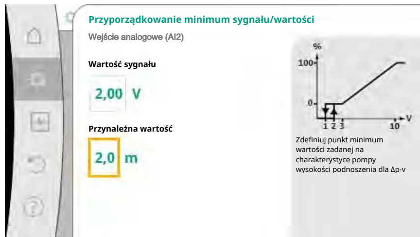
Fig. 75: Przyporządkowanie minimum sygnału/wartości
