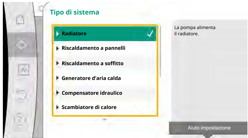
Fig. 47: Esempio tipo di sistema “Radiatore”
