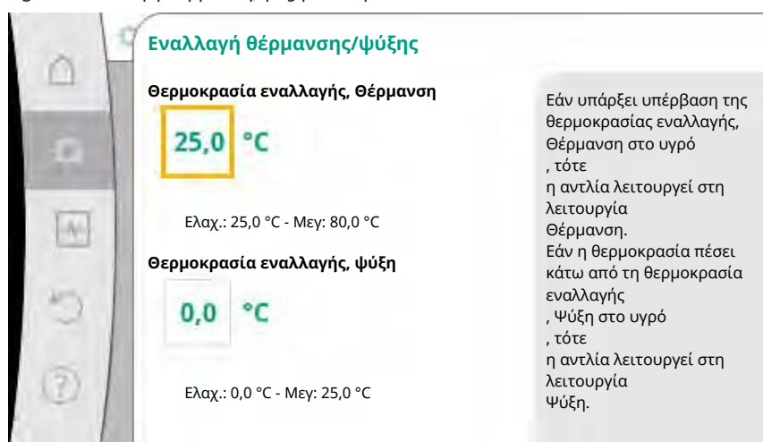
Fig. 57: Εναλλαγή θέρμανση/ψύξη_Θερμοκρασίες εναλλαγής
