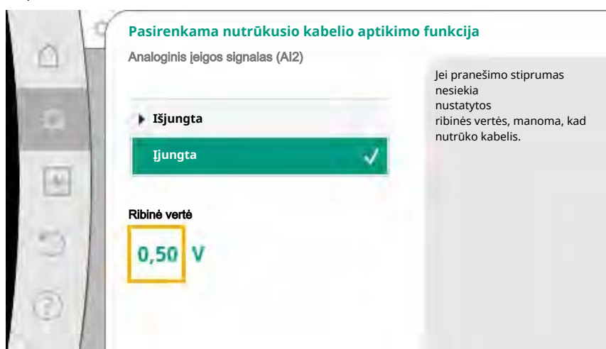
Fig. 72: Nutrūkusių kabelio ribinė vertė
