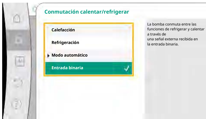
Fig. 58: Conmutación calentar/refrigerar_Entrada binaria
