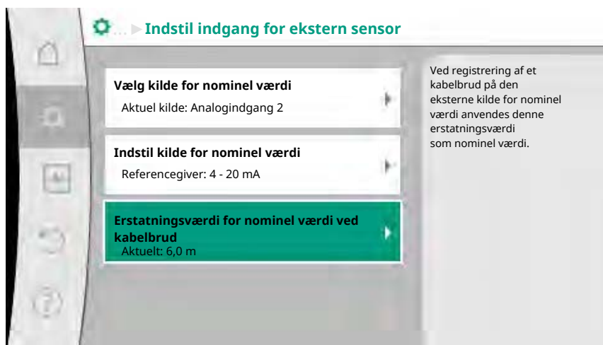
Fig. 77: Erstatningsværdi for nominal værdi ved kabelbrud
