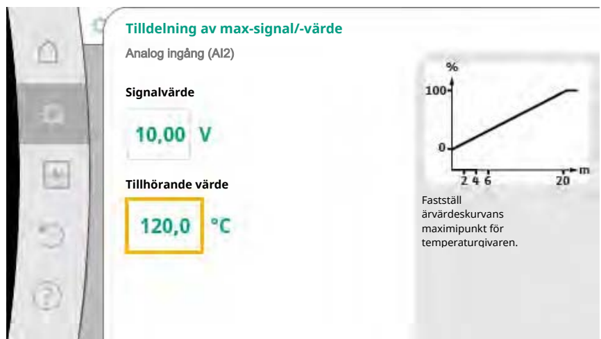
Fig. 81: Tilldelning av max-signal/-värde ärvärdesgivare
