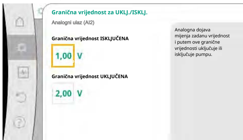
Fig. 74: Granične vrijednosti za upravljanje UKLJ./ISKLJ. putem analognih signala
