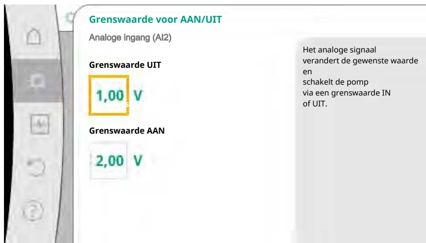
Fig. 74: Grenswaarden voor AAN/UIT-besturing via analoge signalen
