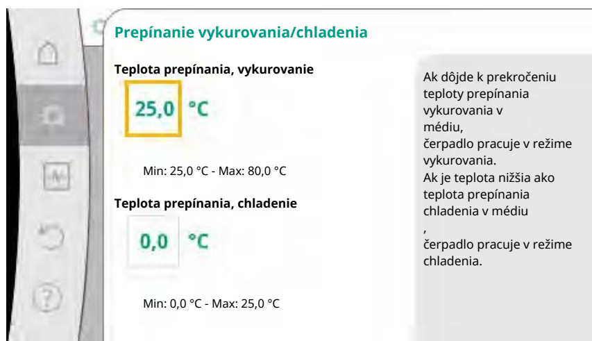
Fig. 57: Prepínanie Vykurovanie/Chladenie_teplota prepínania
