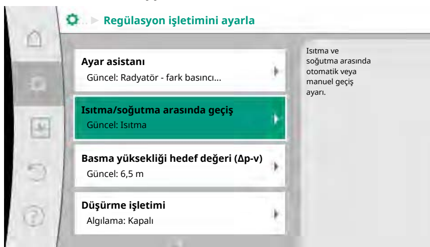
Fig. 53: Isıtma/soğutma arasında geçiş
