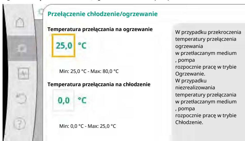
Fig. 57: Przełączenie chłodzenie/ogrzewanie_temperatury przełączania
