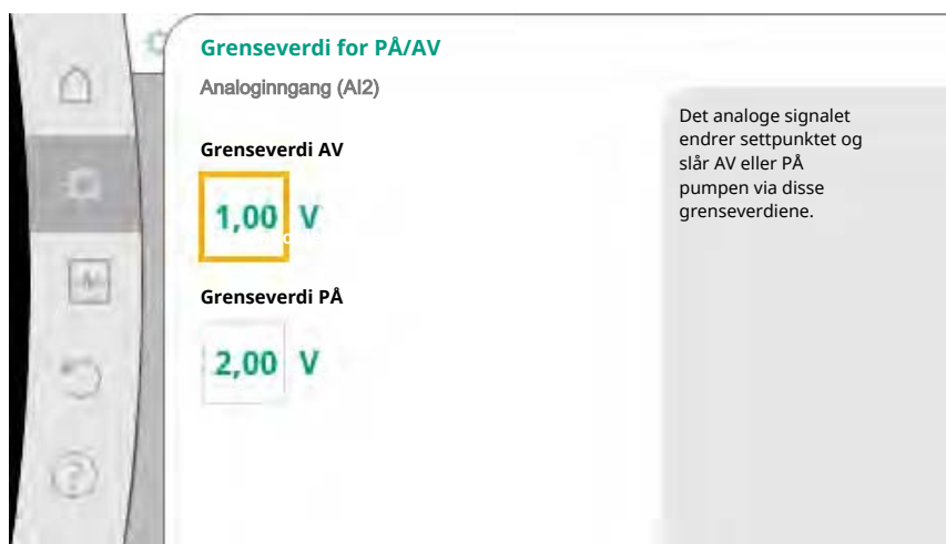
Fig. 74: Grenseverdier for AV/PÅ-styring via analogsignaler
