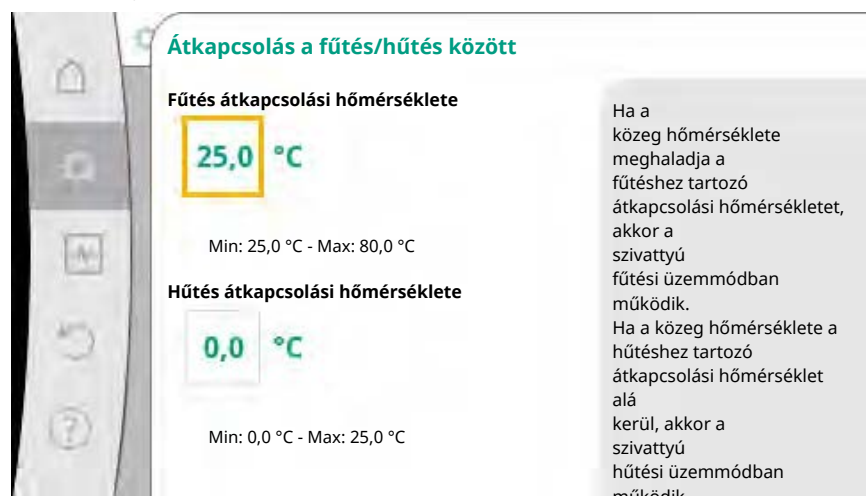
Fig. 57: Átkapcsolás a fűtés/hűtés között_Átkapcsolási hőmérsékletek
