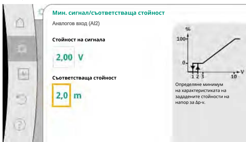
Fig. 75: Мин. сигнал/съответстваща стойност
