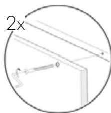
**6** Установите шканы в отверстия в торцах опор. Легкими ударами молотка забейте их в отверстия, оставив снаружи не более 12мм.
