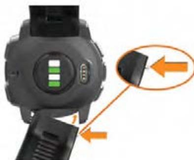
**ПРИМЕЧАНИЕ.** убедитесь, что ремешок закреплен надежно. Штырек часов должен входить в отверстия на устройстве.
