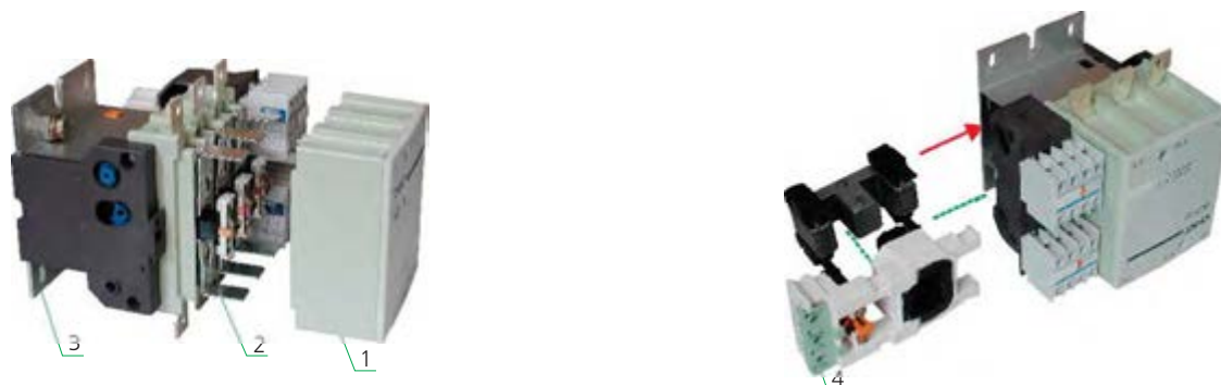
1: Дугогасительная система 2: Контактная система 3: Основание 4: Магнитная система
