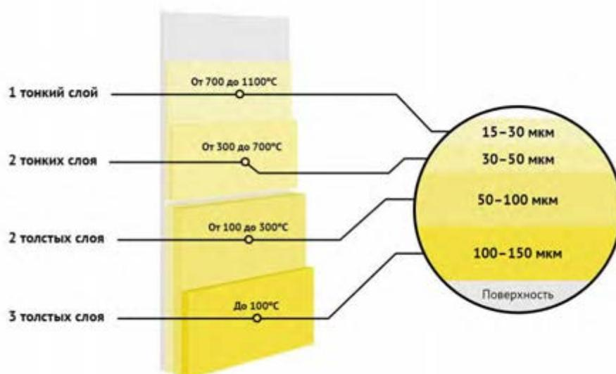
Эмаль не теряет свои свойства при резком колебании температур и повышенной влажности. Благодаря этому термостойкая эмаль Elcon может использоваться для окрашивания поверхностей и оборудования в помещениях с высоким перепадом температур.
