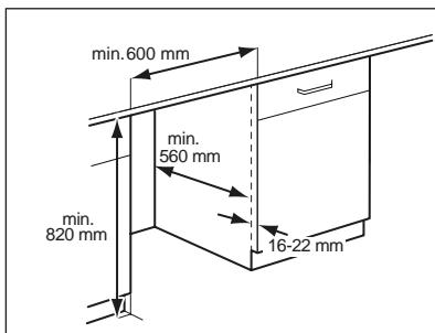
Данный прибор рассчитан на встраивание в кухонную мебель. Размеры ниши для встраивания прибора указаны на данном рисунке.
