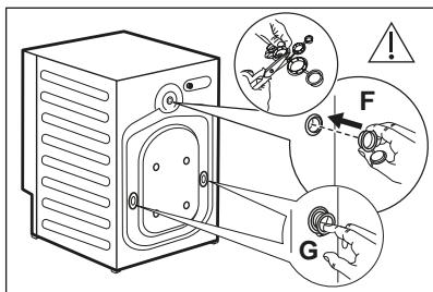
**7.** Закройте отверстия пластиковыми заглушками, которые находятся в пакете с руководством пользователя. Вставьте заглушку наименьшего размера **F** в верхнее отверстие, а две заглушки большего размера **G** — в нижние отверстия.
