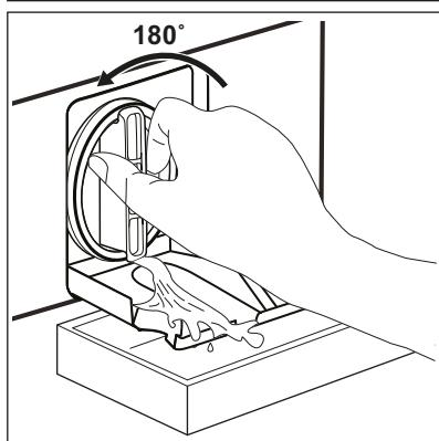
3. Чтобы снять фильтр, поверните его против часовой стрелки на 180 градусов, не вынимая. Дайте воде вытечь.
