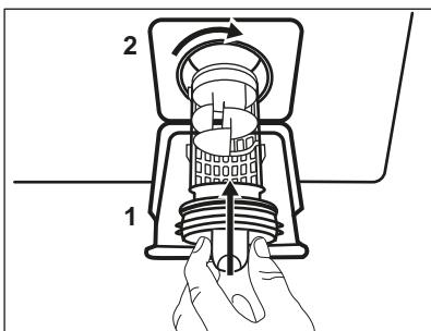
9. Вставьте фильтр обратно по специальным направляющим, поворачивая его по часовой стрелке. Убедитесь, что фильтр затянут надлежащим образом во избежание протечек.
