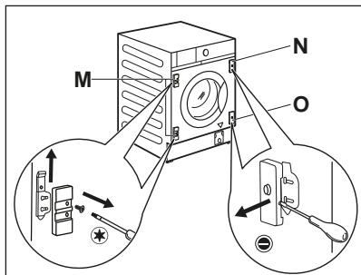
Если дверца кухонной мебели должна открываться слева направо, перенесите на другую сторону опоры петель **M**, магнитную пластину **N** и нижнюю пластину **O**.
