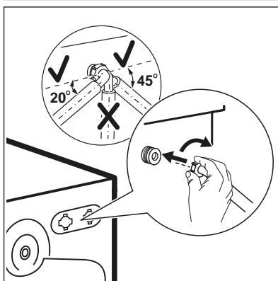
3. Подсоедините шланг к задней части прибора. Не поворачивайте наливной шланг вниз; вместо этого расположите его так, чтобы он шел вправо или влево в зависимости от расположения водопроводного вентиля.
