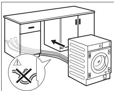
Перед тем, как продолжить встраивание прибора, расположите его рядом с нишней и заранее разместите наливной и сливной, а также сетевой шнур.
