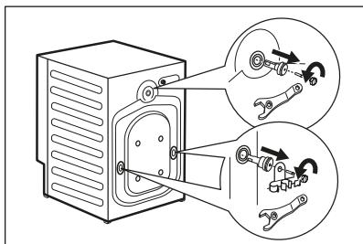
**6.** Извлеките три болта, держатели шлангов и пластиковые вставки с помощью ключа, входящего в комплект поставки прибора.
