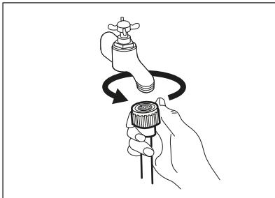
5. Присоедините наливной шланг к водопроводному крану холодной воды с резьбой 3/4 дюйма.
