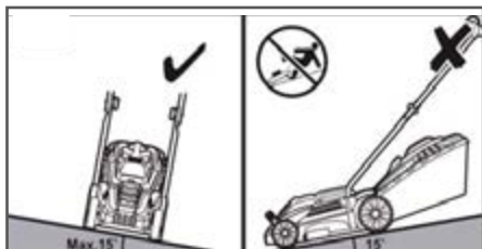
Рис. 12 Положение газонокосилки при кошении.
