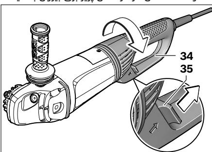
دسته اصلی 34 در محور بدنه موتور تا 90° درجه به سمت چپ و یا راست قابل چرخش است. به این ترتیب میتوان کلید روشن/خاموش را برای مواد ویژه کار در وضعیت مناسب برای کار بردن و دسترسی به آن قرار داد. از جمله برای پرش کاری و جداسازی با سریوش مکنده و راهنمایی پرش 18 و برای استفاده افراد چپ دست مناسب است.
