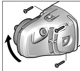
Редукторная головка может поворачиваться с интервалом в 90°. Таким образом выключатель может быть установлен в удобное для работы положение, например, для отрезных работ с вытяжным колпаком и направляющими салазками **18** или для левши.
