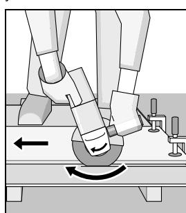
Elektrikli el aleti daima dönde yönünün tersine yönlendirilmelidir. Aksi takdirde alet **kontrol-dan** ve kesme hattından çıkabilir.
