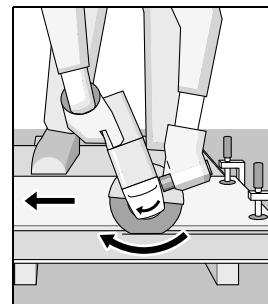
Всегда ведите электроинструмент против направления вращения. В противном случае возникает опасность **неконтролируемого** выхода из прорези.
