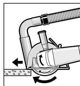
Включите электроинструмент и установите его передней частью направляющие салазки на деталь. Перемещайте электроинструмент с умеренной, соответствующей обрабатываемому материалу подачей.
