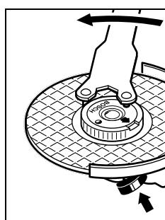
Закріплену належним чином, непошкоджену швидкозатиску гайку можна відпустити, вручну повертуючи кільце з накаткою проти стрілки годинника.
