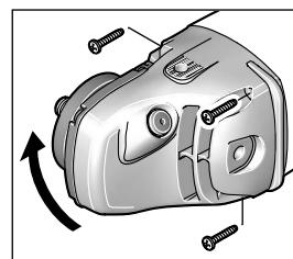
Повністю викрутіть 4 гвинти. Обережно поверніть головку редуктора, **не знімаючи її з корпуса** в нове положення. Знову затягніть тугу 4 гвинти.
