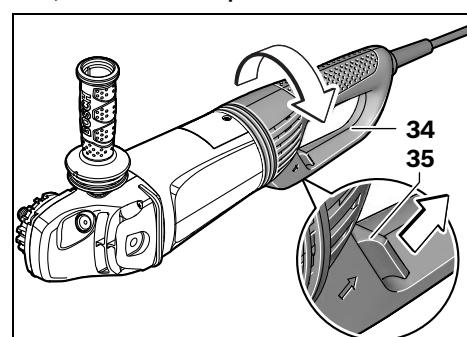
Il est possible de faire pivoter la poignée principale 34 de 90° vers la gauche ou vers la droite par rapport au carter moteur. Ceci permet de mettre l'interrupteur Marche/Arrêt dans une position de maniement favorable à des utilisations spécifiques, p. ex. pour des travaux de tronçonnage effectués au moyen du carter d'aspiration avec glissière de guidage 18 ou pour les gauchers.
