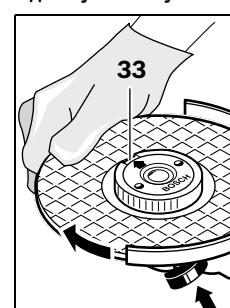
Натисніть на фіксатор шпинделя **1**, щоб зупинити шліфувальний шпиндель. Для затягнення швидкозатисконої гайки з силою поверніть шліфувальний круг за стрілкою годинника.
