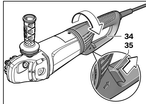
Головну рукоятку **34** можна повертати відповідно до корпуса мотора на 90° ліворуч або праворуч. Завдяки цьому вимикач буде знаходитися у більш зручному для певних видів роботи положенні, напр., при роботі з витяжним ковпаком з направлюючою шиною **18** або якщо Ви лівша.
