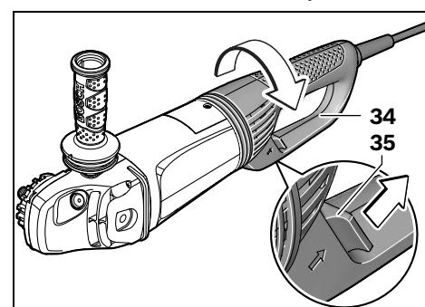
Главную рукоятку **34** можно повернуть на 90° налево или направо. Таким образом выключатель может быть установлен в более удобное для работы положение, например, для отрезных работ с кожухом для отсасывания и направляющими салазками **18** или для левши.
