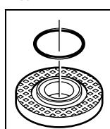
В опорному фланці **5** на центрочому пояску знаходиться пластмасова деталь (кільце круглого перерізу). Якщо кільце круглого перерізу відсутнє або пошкоджене, опорний фланець **5** необхідно обов'язково замінити перед подальшим використанням.
