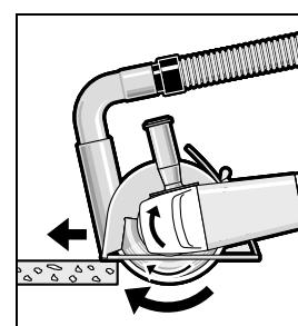
Elektrikli el aletini çalıştırın ve kılavuz kızığın ön kısmını iş parçası üzerine yerleştirin. Elektrikli el aletini makul ve işlenen malzemeye uygun bir bastırma kuvveti ile hareket ettirin.
