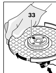
Для фиксирования шлифовального шпинделя нажмите кнопку фиксации шпинделя **1**. Для затягивания быстрозажимной гайки поверните шлифовальный круг с усилием по часовой стрелке.
