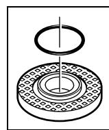
На опорном фланце **5** вокруг центрирующего буртика находится пластмассовая деталь (кольцо круглого сечения). **Если кольцо круглого сечения отсутствует или повреждено**, опорный фланец **5** необходимо обязательно заменить перед дальнейшим применением.
