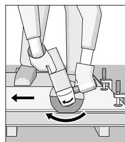
هنگام برش بروfil ها و لوله های چهارضلعی، بهتر است از کوچکترین ضلع مقطع برش شروع بکار نمایید.
