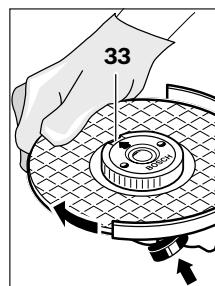
یک مهار سریع ( SDS ۹) بد و نمون نص که به درستی مکم شده است، را میتوانید بواسیله دست از طریق چرخش بلطف شیاردار آن، در خلاف جهت حرکت عقریه ساخت باز کنید.
