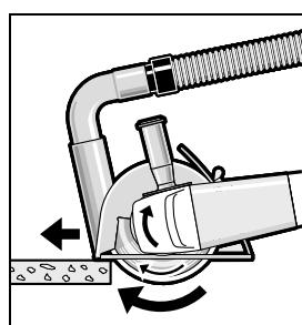
Увімкніть електроприлад і приставте його передньою частиною люнетного супорта до оброблюваного матеріалу. Помірно просувайте електроприлад у відповідності до оброблюваного матеріалу.
