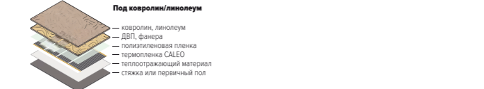
Рис. Схема монтажа теплого пола CALEO под ковролин или линолеум
