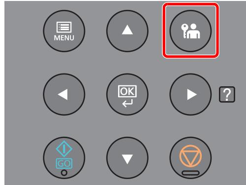
Нажмите клавишу [**Выход из системы**] для выхода из экрана параметров и выхода из системы. Аппарат вернется к обычному экрану.
