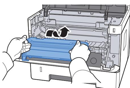
**13 Верните узел проявки вместе с контейнером с тонером в его изначальное положение так, чтобы направляющие с обоих концов совпали с пазами в аппарате.**
