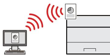
При наличии беспроводной ЛВС можно установить аппарат, не заботясь о сетевых кабелях. Кроме того, поддерживаются функции Wi-Fi Direct и т. д.
