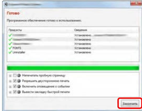
Когда появится сообщение "**Программное обеспечение готово к использованию**", можно начинать использование программного обеспечения. Для печати тестовой страницы установите флажок "**Напечатать пробную страницу**" и выберите аппарат.
