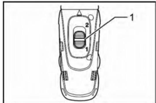
**ПРЕДУПРЕЖДЕНИЕ! Всегда полностью переводите переключатель передач в правильное положение. Если Вы работаете с инструментом, а переключатель передач находится посередине между обозначениями "1" и "2", это может привести к повреждению инструмента.**
