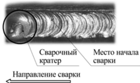
Рис. 8.4. Начало сварки при смене электрода.
