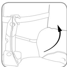
Потяните ручку отрезного ножа, чтобы разрезать ленту.
