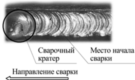
Рис. 8.4. Начало сварки при смене электрода.
