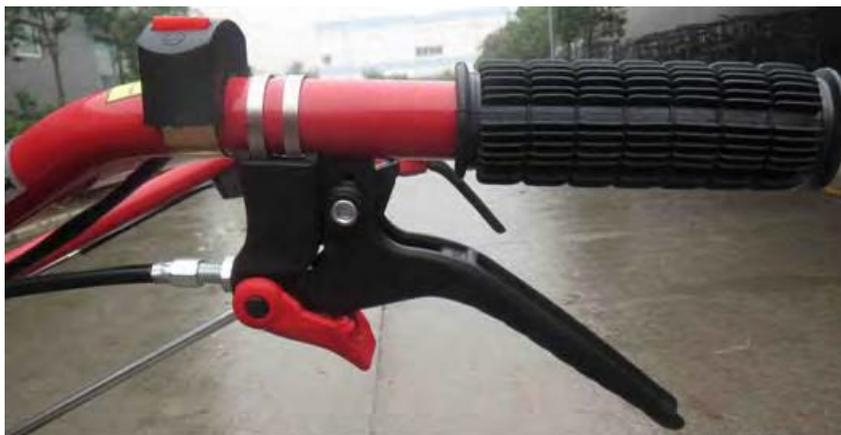
4. Переведите рычаг переключения в нейтральное положение. Это среднее положение между первой и второй передачами (стрелка N на рисунке). Если Вы впервые сталкиваетесь с подобной системой переключения - опробуйте все режимы. Включение передачи сопровождается характерным «защелкиванием» рычага в передачу. Переключение между движением вперед и назад также должно происходить с выжимом сцепления.
