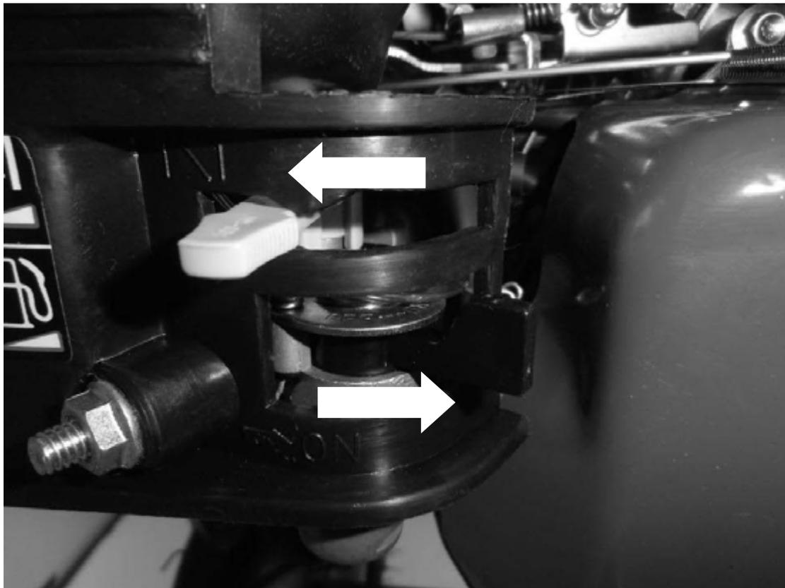
Верхний рычажок — управление воздушной заслонкой. При запуске он должен находиться в положении «закрыто» - крайнее левое положение. Таким образом, мы изменим состав смеси, обогащая его топливом. Если воздушная заслонка останется открытой топливная смесь будет обедненной, при таком составе смеси запуск затруднен или невозможен.
