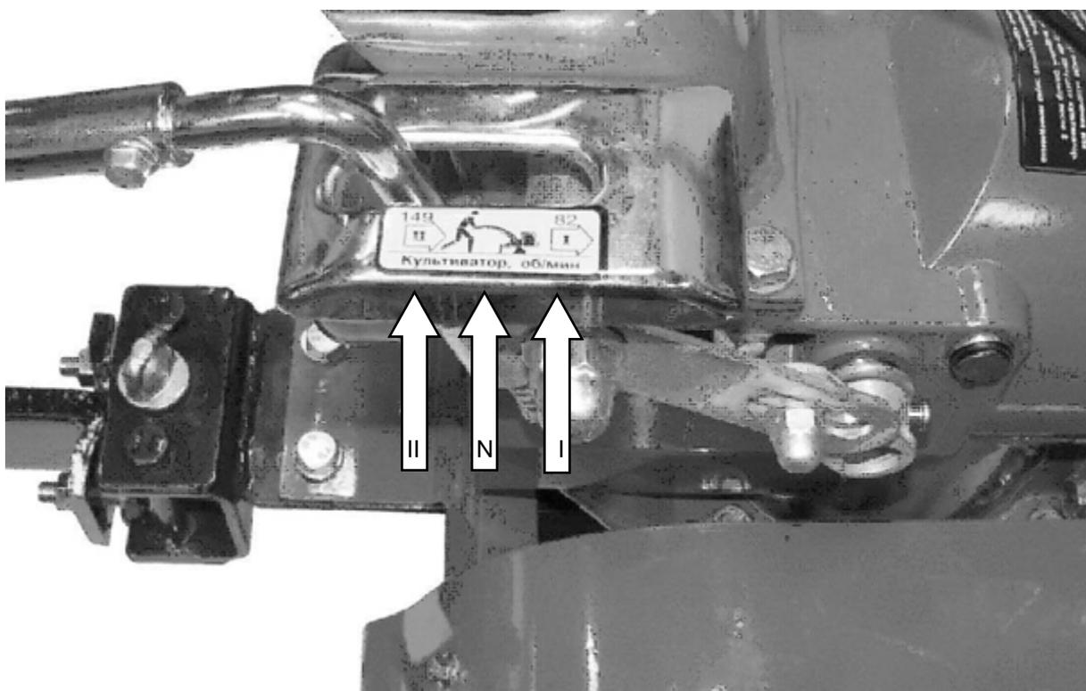
Ручка включения заднего хода расположена на правой рукоятке. Ее самопроизвольное нажатие блокирует специальный фиксатор, не нажав на который у Вас не получится зажать ручку включения задней передачи. Прежде, чем включить заднюю передачу необходимо:
