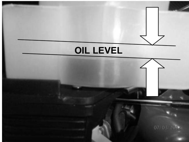
Заливка масла в редуктор. Выкрутите щуп-пробку (серого цвета) из редуктора . Залейте свежее, чистое масло в редуктор (около 1,9 литра масла). Используйте трансмиссионное масло SAE 80W90, SAE 85W90, ТАД 17 или аналогичное. Уровень контролируйте по щупу. Для этого протрите щуп ветошью, закрутите его до упора и выкрутите снова. Вы увидите уровень на щупе .
