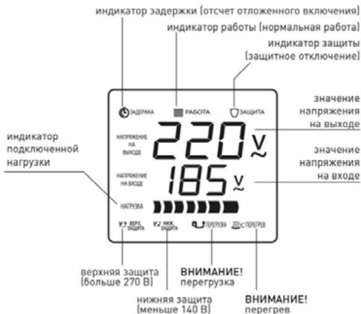
Индикация режимов работы стабилизатора.
