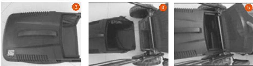
1. Поднимите защитную крышку выброса (рис.4).
