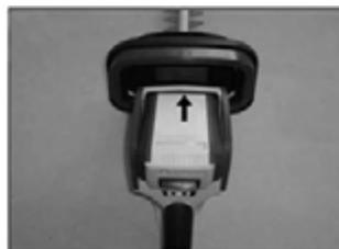
2. Снятие аккумуляторной батареи. Нажмите и удерживайте кнопку фиксатора аккумулятора в нижней части батарейного блока. Извлеките аккумулятор из устройства.
