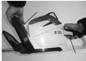
2. Запуск устройства: сначала нажмите на кнопочный переключатель на передней рукоятке, затем триггер переключателя на задней рукоятке.
