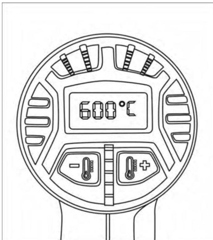
Рис.3 Регулировка температурного режима ФЭ-2000ЭКД
