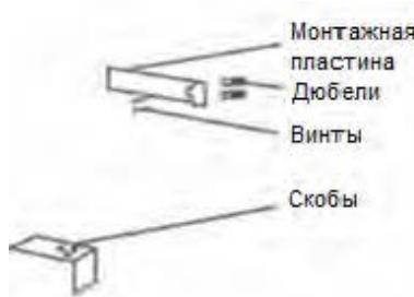
Требования по креплению обогревателя на стену: прибор должен быть прикреплен не менее чем в 100 мм от пола, также должно быть свободное пространство не менее 100 мм с боковых сторон, спереди и сверху от него. При установке обогревателя на стену необходимо демонтировать колеса с опорами, если они уже установлены. Разметьте необходимое количество отверстий для крепления на стене и просверлите их. Установите конвектор с помощью комплекта монтажных частей.
