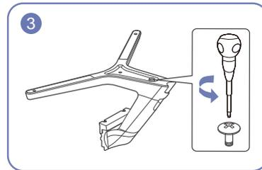
Открутите соединительный винт в нижней части подставки.
