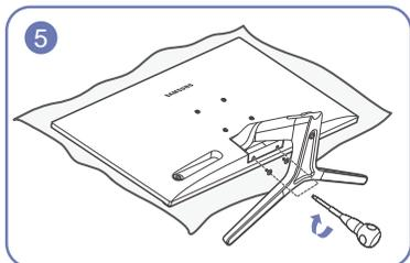
Закрутите винты в нижней части соединительного элемента.
