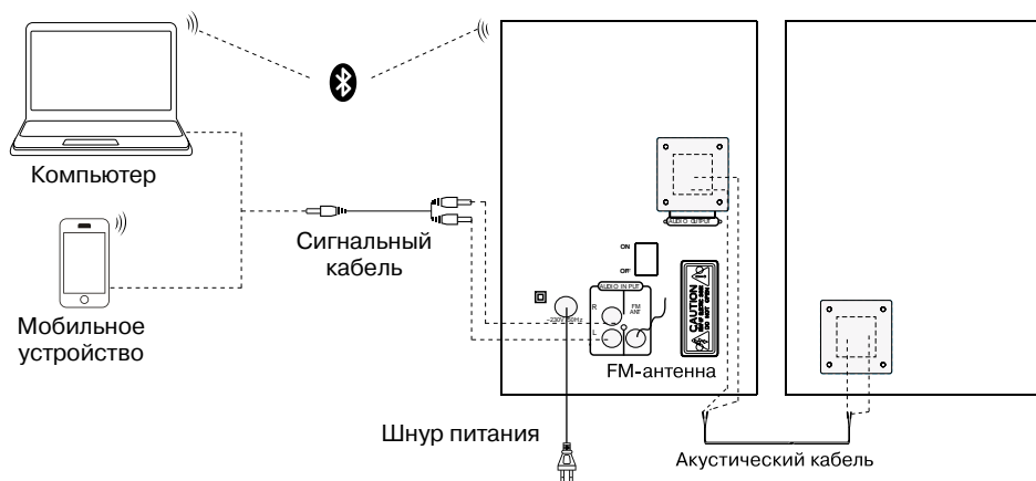
Рис. 4. Схема подключения источников аудиосигнала
