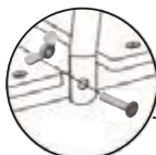
рис. 4 Схема сборки санок
