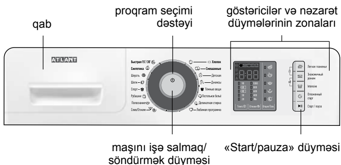
Şəkil 1 – İdarəetmə paneli
