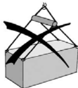
Пример подъема контейнера за четыре крепления в нижних углах
