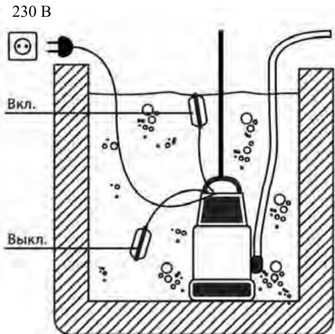
При временной установке насоса рекомендуются гибкие трубы, для постоянной установки рекомендуются жесткие трубы.
