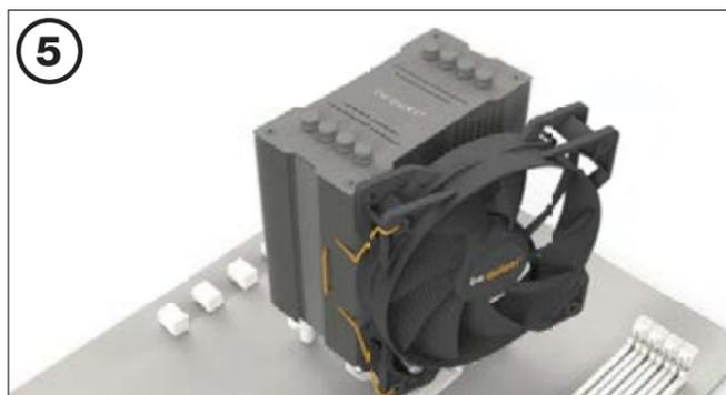
Закрепите 120мм вентилятор (2) на кулере (1) с помощью клипс для вентилятора (15). Подключите вентилятор к PWM разьему материнской платы.
