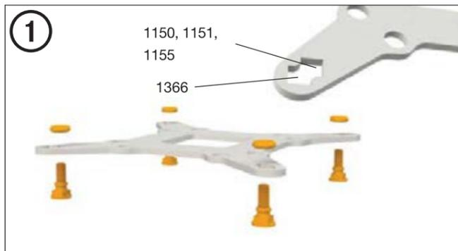
**Монтаж задней пластины**
