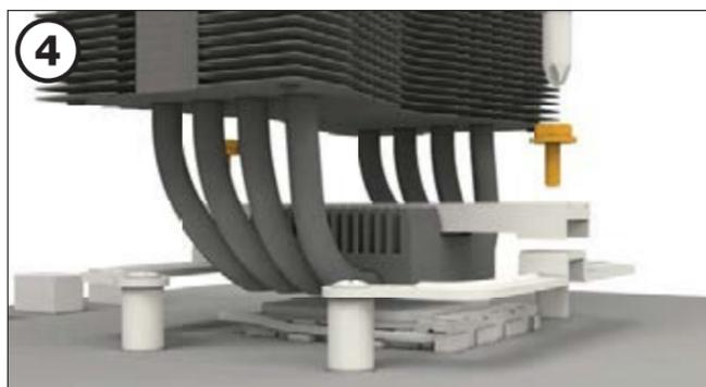
Расположите крепежный мост для кулера (6) по центру кулера (1). Установите кулер на процессор. Вставьте винты крепежного моста (11) в отверстия крепежного моста для кулера и попеременно затяните их. Используйте любую крестовую отвертку.
