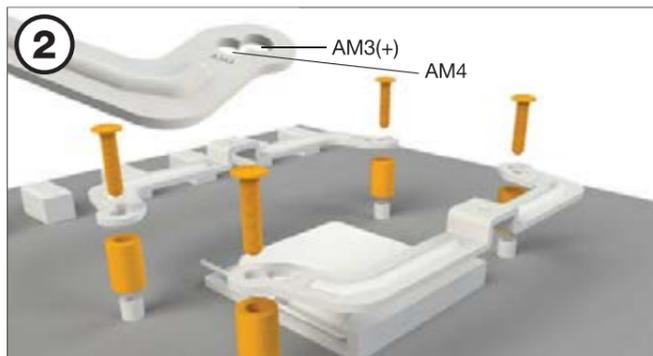
Наживите 4 распорные гайки AMD (9) на выступающие через переднюю часть материнской платы болты задней панели и закрепите короткие AMD кронштейны (5) винтами задней пластины AMD (13).
