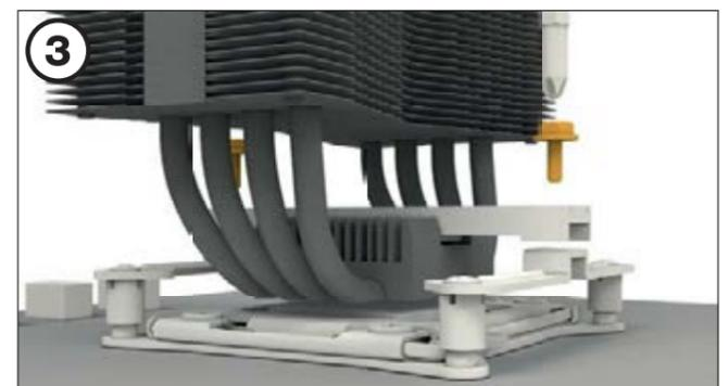
Расположите крепежный мост для кулера (6) по центру кулера (1). Установите кулер на процессор. Вставьте винты крепежного моста (11) в отверстия крепежного моста для кулера и попеременно затяните их.
