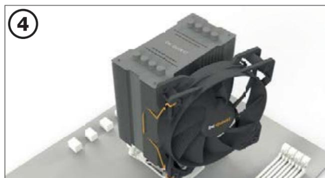
Закрепите 120мм вентилятор (2) на кулере (1) с помощью клипс для вентилятора (15). Подключите вентилятор к PWM разъему материнской платы.
