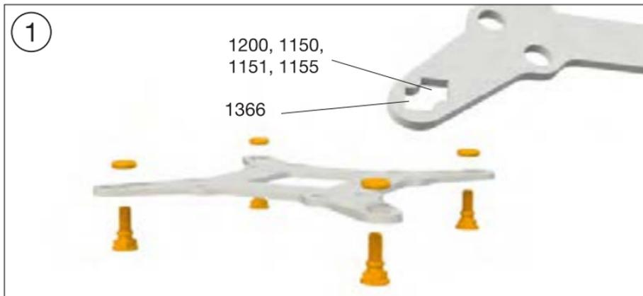
**Монтаж задней пластины**
