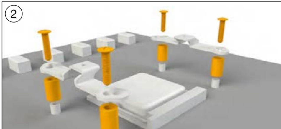
Установите четыре распорные гайки AMD (8) на выступающие через переднюю часть материнской платы болты задней панели и закрепите короткие монтажные кронштейны AMD (5) винтами задней пластины AMD (11).
