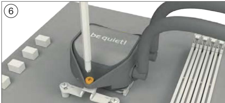
Разместите блок охлаждения процессора по центру над монтажными кронштейнами AMD (5) и закрепите его. Для этого вы можете использовать обычную крестовую отвертку. Затем подключите помпу и светодиодную подсветку к SATA-переходнику (18).
