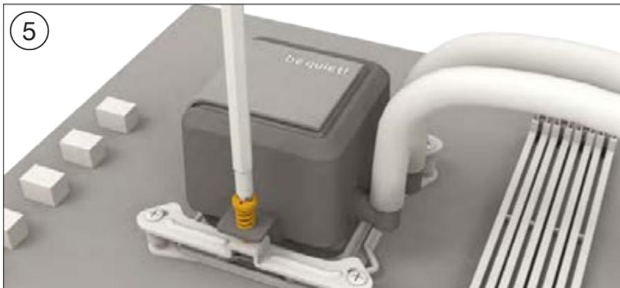
Разместите блок охлаждения процессора по центру над монтажными кронштейнами Intel (4 и закрепите его. Для этого вы можете использовать обычную крестовую отвертку.
