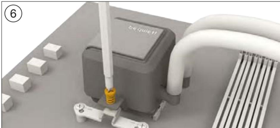
Разместите блок охлаждения процессора по центру над монтажными кронштейнами AMD (5) и закрепите его. Для этого вы можете использовать обычную крестовую отвертку. Далее подключите помпу к материнской плате.
