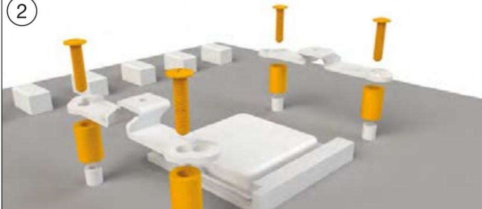
Установите четыре Проставки AMD (8) на выступающие через переднюю часть материнской платы болты задней панели и закрепите короткие монтажные кронштейны AMD (5) винтами задней пластины AMD (11).
