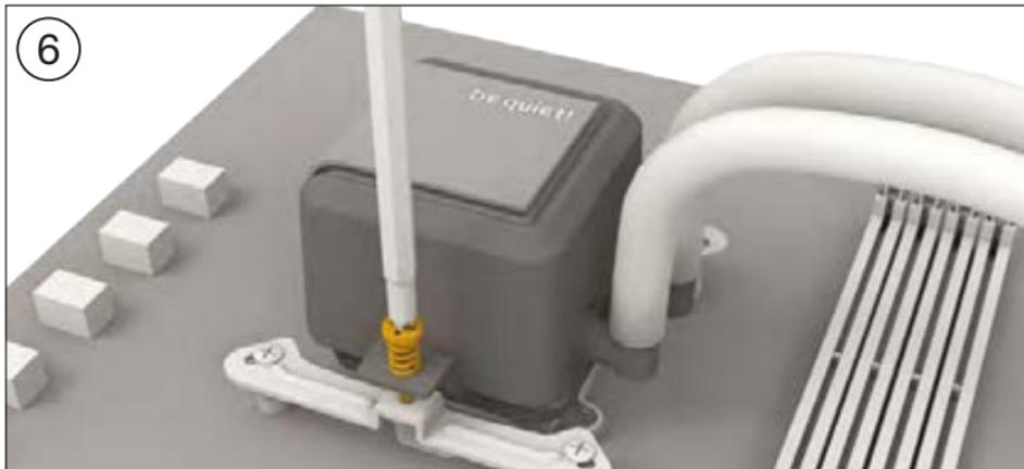
Разместите блок охлаждения процессора по центру над монтажными кронштейнами Intel (4) и закрепите его. Для этого вы можете использовать обычную крестовую отвертку. Далее подключите помпу к материнской плате.
