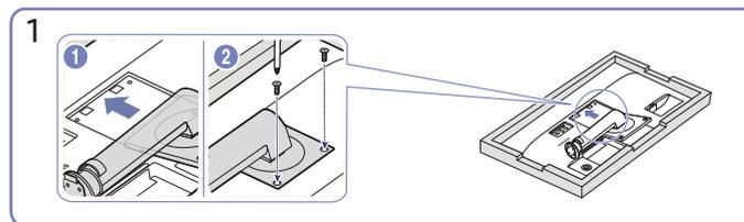
Вставьте соединительный элемент подставки в корпус в направлении стрелки, как показано на рисунке. Крепко закрутите соединительный винт в нижней части подставки.
