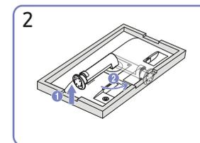
Поверните соединительный элемент подставки на мониторе против часовой стрелки на 90°.
