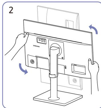
Поверните устройство в самое высокое вертикальное положение.
