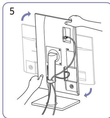
Поверните устройство в горизонтальное положение.
