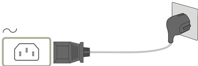
Для работы с устройством подключите кабель питания к электрической розетке и порту
