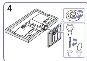
Вставьте основание подставки в подставку в направлении, показанном стрелкой. Надежно заверните винт (при помощи отвертки или монетки) в нижней части основания подставки.
