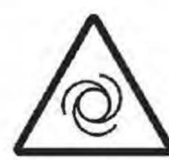
Danger - automatic control (closed loop) Опасность автоматического включения
