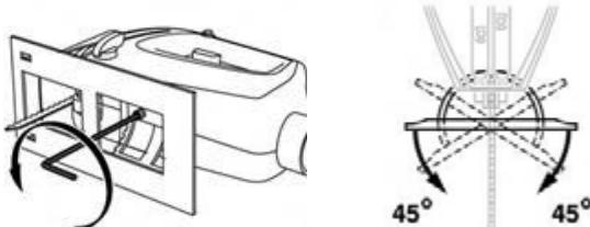
**Помните!** Пиление под углом производится только в прямом направлении. Изменение направления пиления может привести к поломке пильного полотна и, как следствие, к травмам.
