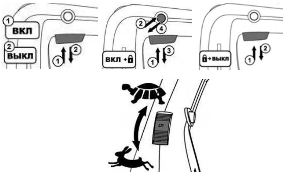
Б) Для выключения электролобзика стоит отпустить кнопку включения (3). Если кнопка включения была заблокирована фиксатором (2), его следует сначала разблокировать кратковременным нажатием на кнопку включения (3).
