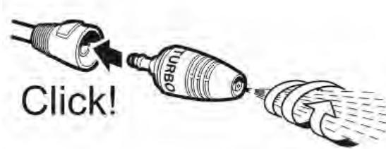
Установите головку роторной форсунки TURBO в удлинительную насадку. Головка фиксируется быстросъемным соединением. Для того, чтобы извлечь головку, нажмите на кнопку и достаньте головку.
