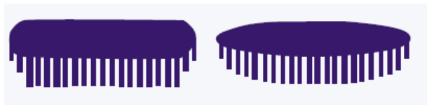
Образцы с нормальным распределением материала в факеле
