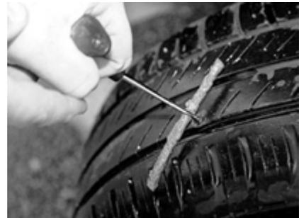
4. Аккуратно извлечь инструмент, жгут должен остаться в шине. Лишний торчащий жгут отрезать, оставить только 2-3 миллиметра.
